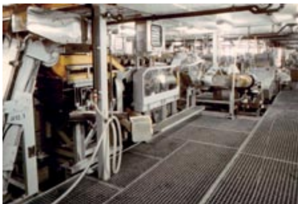
GUP rister benyttes som gulv, gangbaner, plattformer og trapper i kjemisk industri, papir- og celluloseindustri, næringsmiddelindustri, rensesanlegg og offshoreindustri
